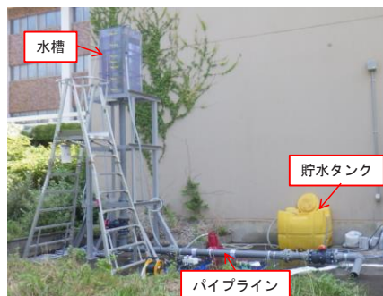
Fig. 1 モデルパイプラインにおける実験状況 Experimental situation in model pipeline
